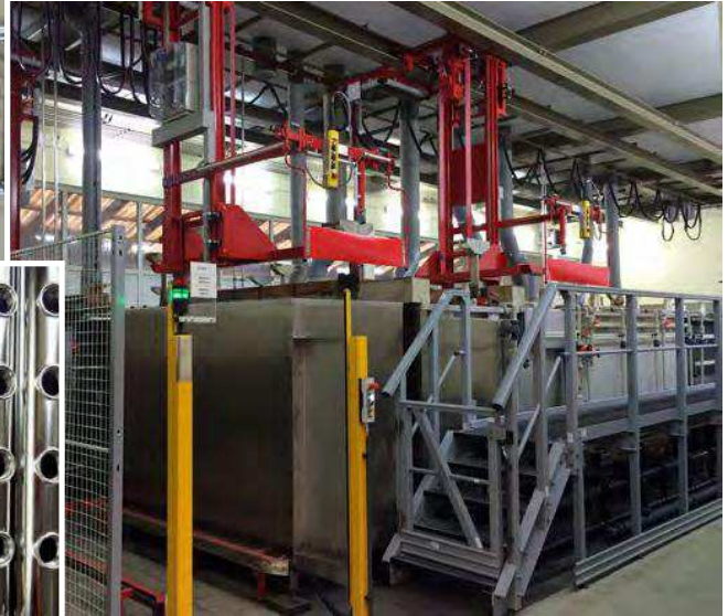
Die neue Elektropolieranlage sowie einige der von der Strähle-Galvanik GmbH elektropolierten Teile
